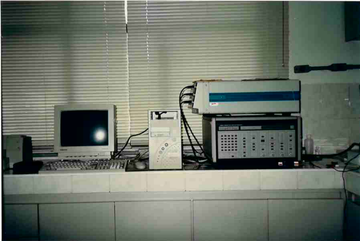
Figura 8 - Potenciostato/Galvanostato modelo 273A da EG & G Instruments - Princeton Applied Research utilizado no ensaio de polarização potenciodinâmica.
