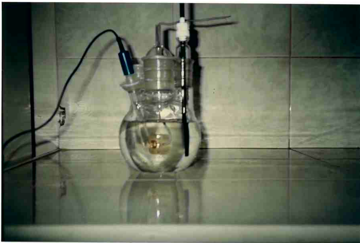
Figura 6 – Arranjo experimental composto de uma célula, um eletrodo de trabalho, um eletrodo de grafita e solução de H_2SO_4 0,5 M a temperatura ambiente, utilizado nas medidas do potencial de corrosão em função do tempo de imersão das amostras.
